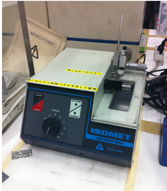
図 3.6. ダイヤモンドカッター [Model:11-1280-170
