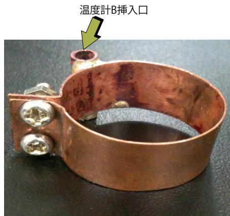
Fig. 3.6: 圧力セルの温度勾配 T_A は圧力セル内部の温度, T_B は圧力セルの外部の温度
